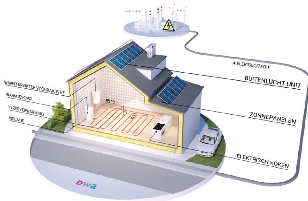
Warmtepomp (bron: DWA)
