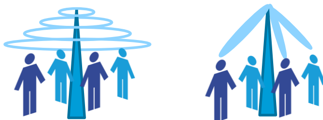
Figuur 4 - Illustratie van de huidige type zendmasten (links) en massive mimo-antennes (rechts)
